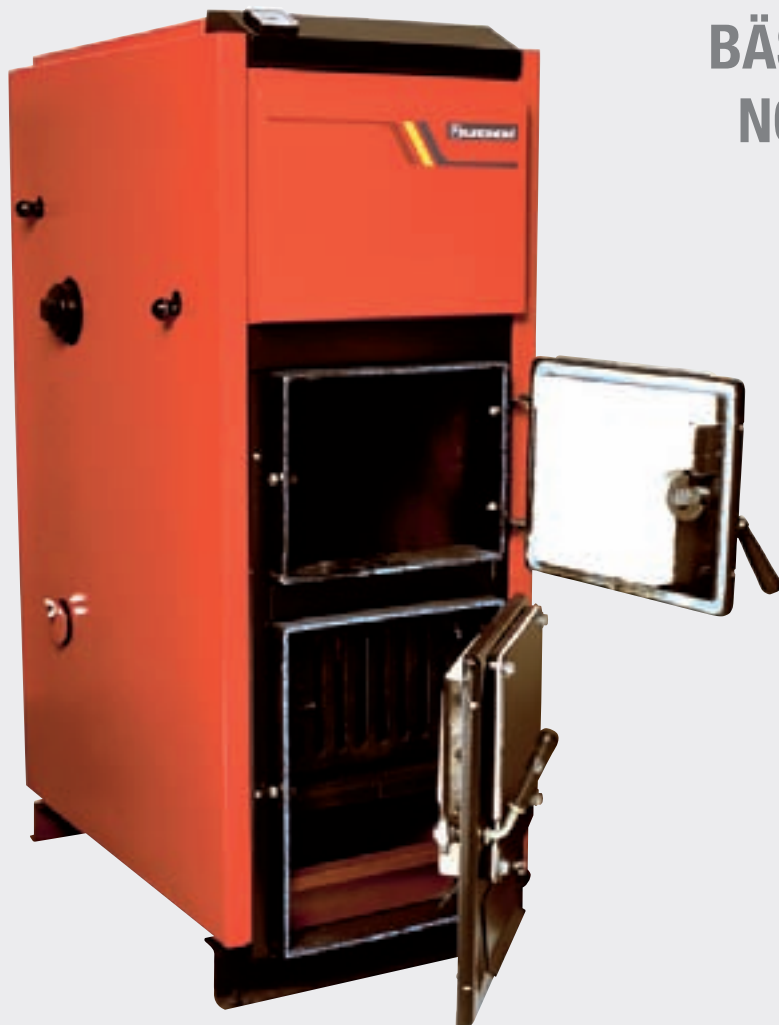
Exonom P20 UB. Luckor med montageplåtar för pelletsbrännare, keramisk isolering på insidan, gallergrind (demonteras vid pellets- och oljeeldning), fastbränslerooster och asklåda.
