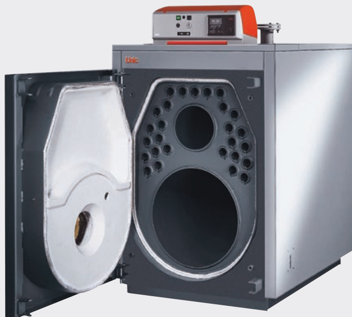
Bilden visar UNIC-TXN med öppen frontlucka. Man kan se den rejäla isoleringen samt flammkammaren, stortuberna och de mindre konvektionstuberna. Denna konstruktion ger till resultat, lägre miljöpåverkan och bättre totalekonomi.
